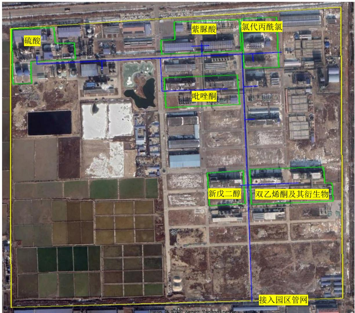
图 3.1.5-6 厂区蒸汽管网布置图 1:6840
