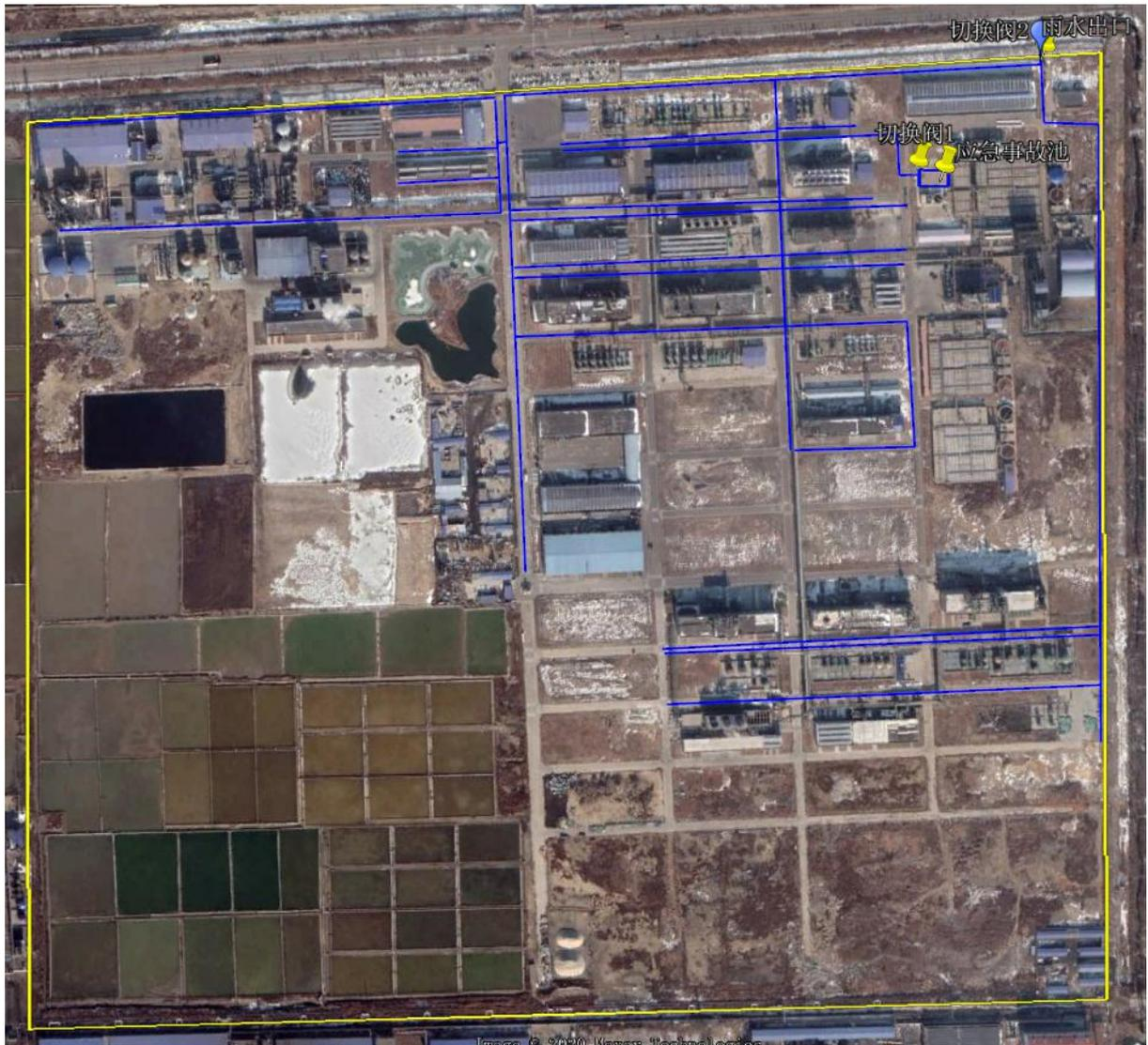
图 3.1.5-4 厂区雨水导排路由图
