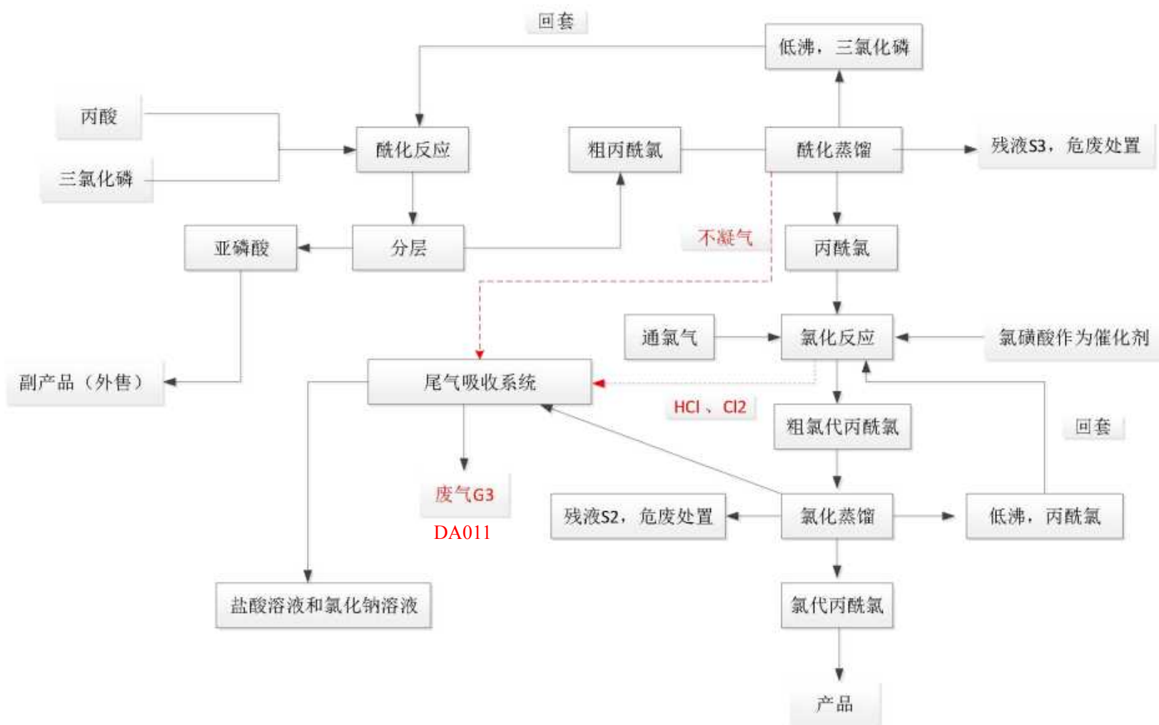
图 2.2-10 氯代丙酰氯合成工艺流程及产污环节图
